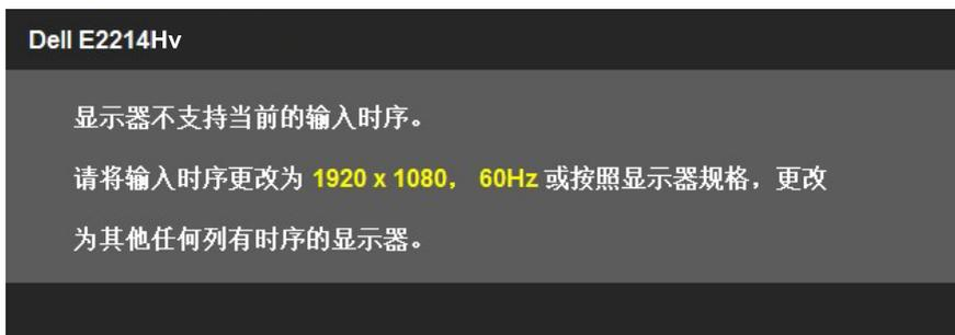
这表示显示器不能与它从计算机接收的信号同步。请参见[显示器规格](#)了解此显示器支持的水平和垂直频率范围。推荐的模式是1920 x 1080。
