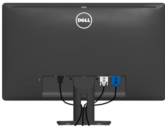
将所有必要电线连接到显示器和计算机后，（电线连接参见“连接显示器”）如上所示管理所有电线。
